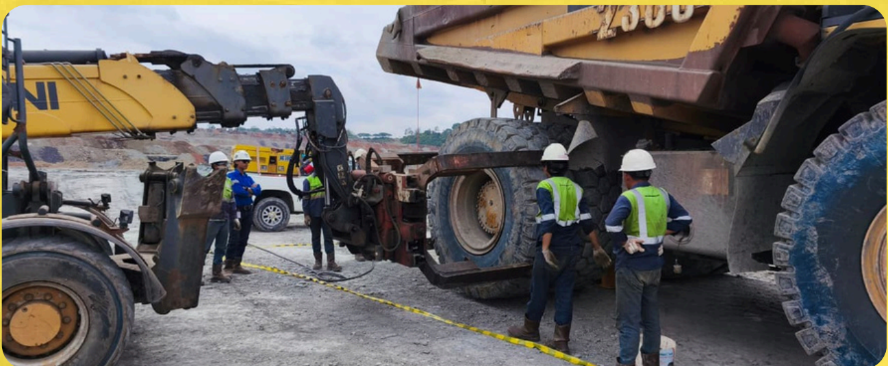
Gambar 3. Proses pemasangan dan penyesuaian ban HD di lapangan
