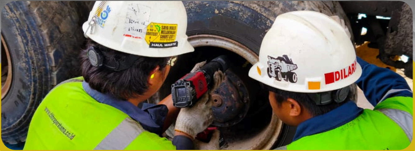
Gambar 1. Proses pemeliharaan ban oleh PT. Chitraparatama di PT CK site PT KIM
