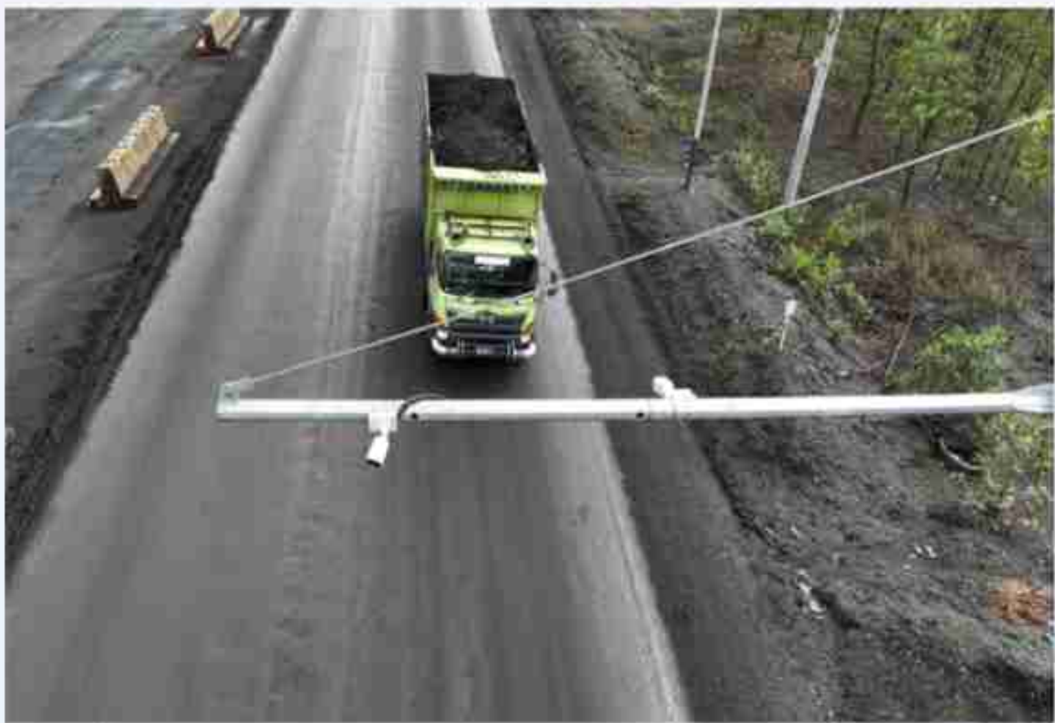
Gambar 2. Kamera CCTV yang ditransformasi menjadi kamera analitik di jalan hauling PT BIB
